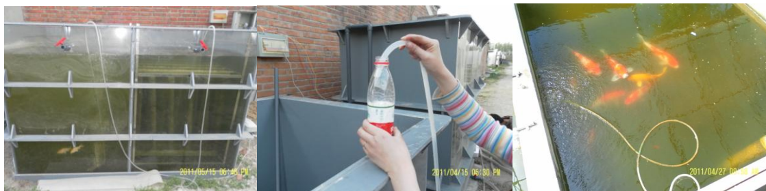
生物碳纤维双层平板膜应用——北京小汤山鸿羽水产养殖水质净化中试
