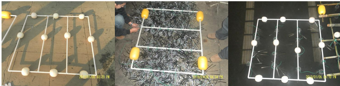
(3) 生物碳纤维填料+聚乙烯泡沫浮岛;
