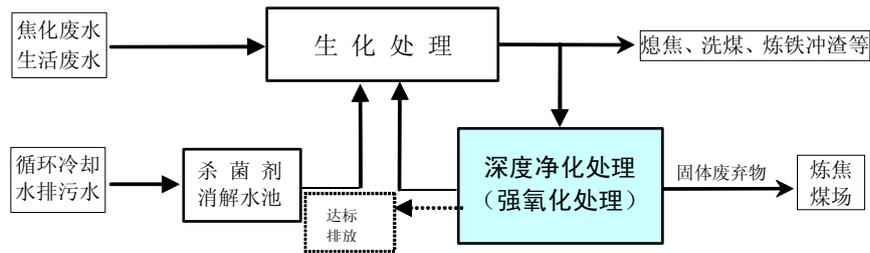
图5 废水深度净化处理工艺流程图之一
