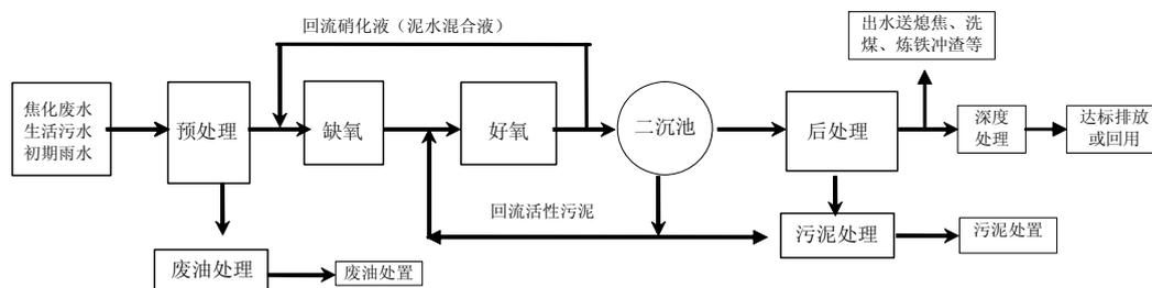
图 2 “缺氧/好氧(A/O)”活性污泥法脱氮工艺流程
